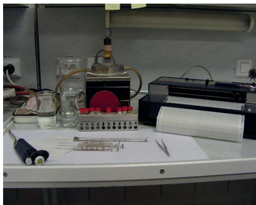
Рис. 1. Полярографическая измерительная установка состоит из электрода Кларка, ячейки с перемешивающим стержнем, термостатируемого кожуха, водяного термостата I ТЖ-0 03 (Россия), магнитной мешалки ММ-3М (Россия), самописца LKB Bromma 2210 2-Channel Recorder (Швеция).
