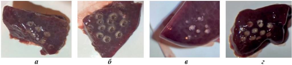
Рис. 7. Воздействие на охлаждённые образцы печени свиньи в непрерывном (а — 6 Вт, б — 10 Вт) и в импульсном режиме (в — 6 Вт, г — 10 Вт).
