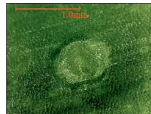
Рис. 7Б. Результат воздействия 1 импульса на лист Сансевиерия лазера «Ланцет-2» с энергией 25 мДж и длительностью 500 мкс. Вид сверху. Ув. 200 X.
