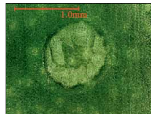
Рис. 7А. Результат воздействия 1 импульса на лист Сансевиерия импульсно-периодического CO 2 -лазера с энергией 30 мДж и длительностью 20 мкс. Вид сверху. Ув. 200 X.
