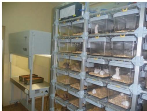
Рис. 1. Изоляторная вентилируемая система «RAIR»
