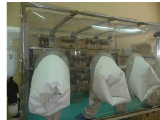
Рис. 3. Гнотобиологический изолятор
