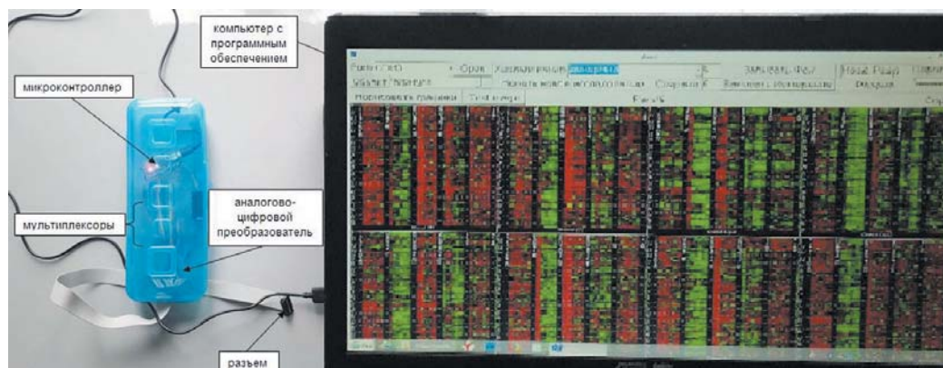
Рис. 2. Микромодуль для исследования интрацентральных отношений головного мозга.
